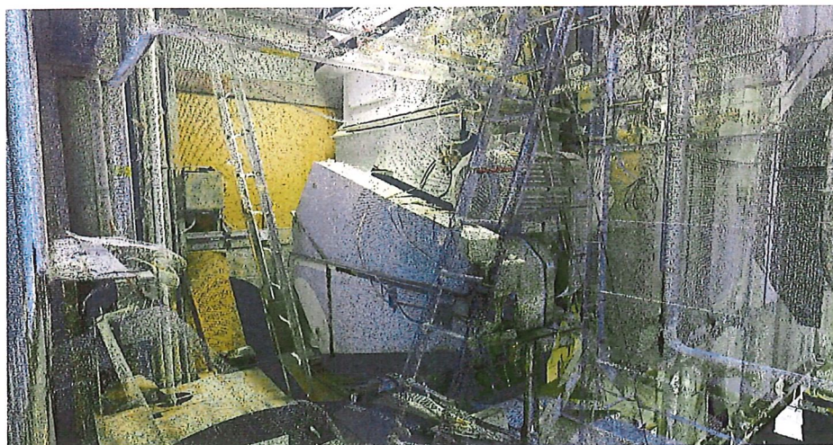
MWHolodeck legde het interieur van een menger van Agruniek vast met de 3D-360°-meetapparatuur.
